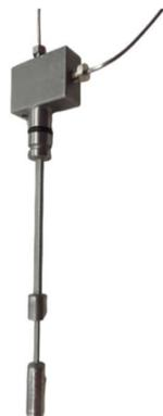
La cellule volumique est remplie en injectant avec une seringue environ 3 mL d'échantillon liquide à analyser. Ce volume permet le remplissage du volume utile de la cellule (0,7 mL), et des tubes de remplissage. Une légère contre-pression est appliquée sur l'échantillon en entrée de la cellule (environ 2 bars) afin de le maintenir pendant la mesure et lui permettre de se dilater lors de la rampe de chauffe.
